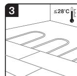
При использовании системы «теплый пол» не превышайте максимально допустимую температуру нагрева покрытия свыше 28 °С.
