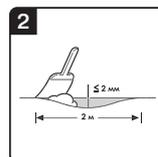
Основание для укладки каменного SPC ламината должно быть ровным, прочным, стабильным, сухим и чистым. Максимально допустимые перепады - 2 мм на 2 погонных метра, а влажность стяжки не превышает 4%.
